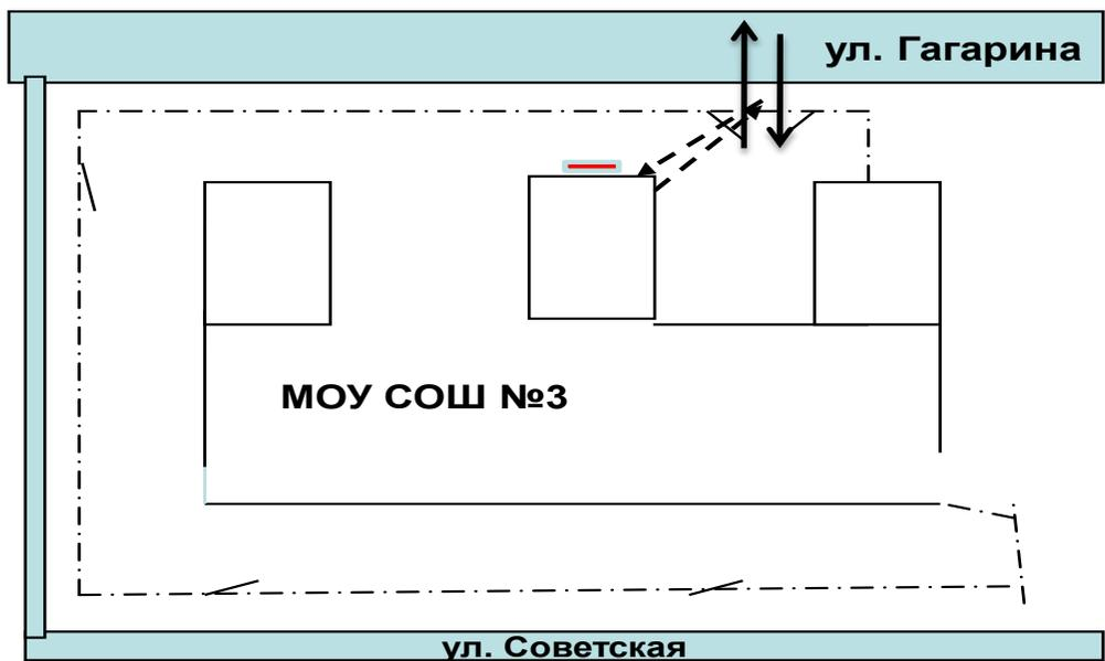
5. План-схема пути движения транспортных средств и обучающихся при проведении дорожных ремонтно-строительных работ вблизи образовательного учреждения
